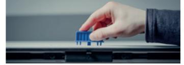
Eine Montagehilfe für das Einsteckgetriebe fixiert dieses bei der Montage der Treibstangen im Profil.
