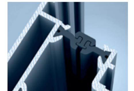
**Schritt 3:** Die Einschubfedern werden wieder eingesetzt. Der Profilverbund bleibt teilweise intakt und auftretende Schubkräfte können sich nicht auf das Getriebe und den Schließzylinder übertragen. Im Bereich des getrennten Verbunds verhält sich das Profil durch die Einschubfeder bei Querszugkräften, die zum Beispiel bei einem Einbruchversuch auftreten, wie ein Profil mit konventionellem Verbund.
