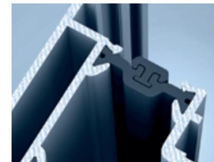
**Étape 1 :** Pour prévenir les effets considérables des écarts de température sur le fonctionnement et l'apparence des éléments coulissants à levage, un profilé composé anti-distorsion breveté a été mis au point. Il protège le profilé des forces de cisaillement néfastes. Ce composé est constitué d'une traverse d'isolation enroulée et d'un ressort d'insertion.
