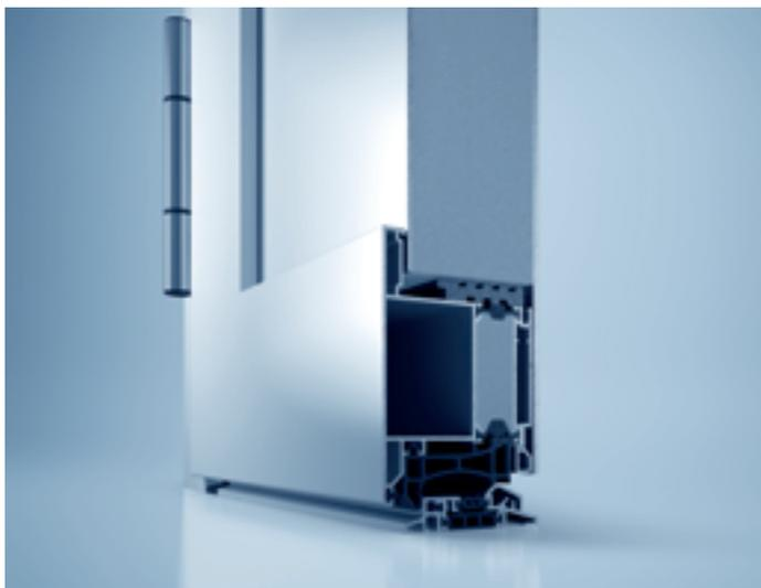
Pour les profilés d'ouvrant heroal D 72 PF « Panel Fixed » à ailette, aucune parclose n'est nécessaire. L'utilisation des matériaux est ainsi optimisée et l'étape d'usinage en moins permet également de raccourcir le délai de fabrication.
