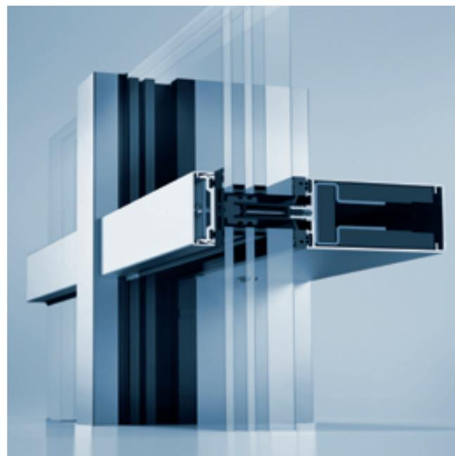
Le système de façade coupe-feu heroal C 50 FP est un élément de construction soumis au marquage CE, qui a été testé par l'ift Rosenheim selon la norme EN 1364-3 et classé selon EN 13501-2. Tous les composants de protection coupe-feu sont encastrés dans la construction, ce qui permet une transition invisible avec les zones de la façade sans exigences de protection.
