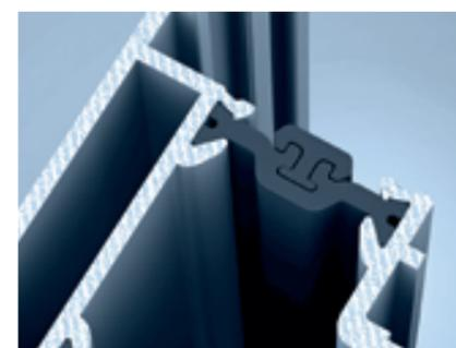
**Krok 1:** Pro zamezení značnému vlivu teplotních rozdílů na funkci a optiku zdvižně posuvných prvků existuje patentovaný profilový spoj heroal zabraňující deformaci. Ten chrání profil před škodlivými posuvnými silami. Tento spoj se skládá z pevně navinutého izolačního můstku a zasouvací pružiny.
