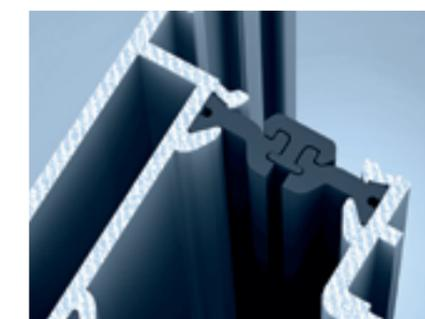
**Krok 3:** Zasouvací pružiny se opět nasadí. Profilový spoj zůstává částečně neporušený a vzniklé posuvné síly se nemohou přenést na hnací mechanismus a zavírací válec. V oblasti odděleného spoje se profil chová v důsledku zasouvací pružiny při příčných tahových silách, které se vyskytují například při pokusu o vzloupání, jako profil s obvyklým spojem.
